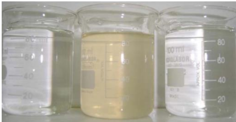
Слева направо: подпиточная вода; обратная вода в период с химической обработкой; обратная вода при работе с системой Гидрофлоу.
