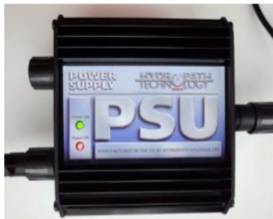
Индикаторы на блоке питания Гидрофлоу
