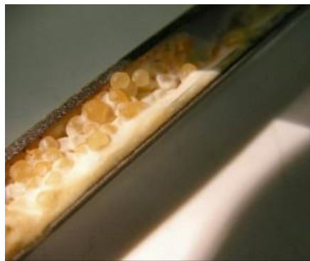
эффект жемчужины': шарики движутся в верхней части трубы, ниже жидкий парафин и вода
